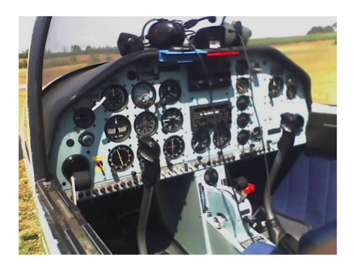
F-22 B Passo Fisso MT-180-140 Elica: Lycoming 0-320-D2A Motore: Potenza: 160 HP Peso Max. Dec.(Utili.): 1875 lbs Peso a vuoto (std.): 1230 lbs Apertura alare: 27.9 feet Lunghezza totale: 24.3 feet Altezza: 9.3 feet Superficie Alare: 116.3 Sq feet Capacità carburante: 35.7 gall Numero posti a bordo: Veloc.max orizz.: 132 kts Rateo di salita: 1000 feet/min
