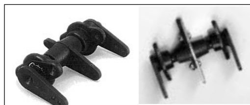
Sistema di precisione per comando elevatore Kato (cod. 111.739), a destra la nostra modifica (cod.111.779) per poterlo utilizzare con due cavetti trecceati.
