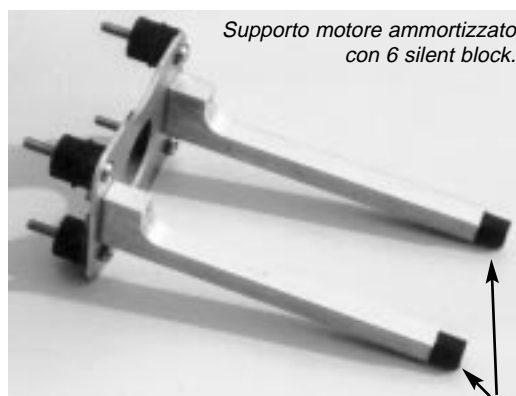
I due gommini anteriori vanno fissati sull'ordinata circolare incollata dietro al "disco ogiva" con due viti a testa svasata da \varnothing 4 MA. I quattro posteriori invece su un'ordinata in compensato di betulla da 4 mm max, incollata esattamente parallela a quella anteriore ad una distanza di circa 15 cm (controllare le misure con il supporto)
