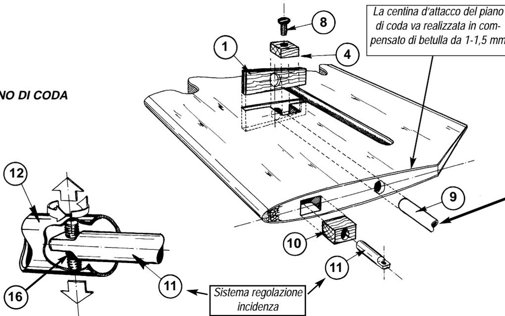
La centina d'attacco del piano di coda va realizzata in compensato di betulla da 1-1,5 mm
